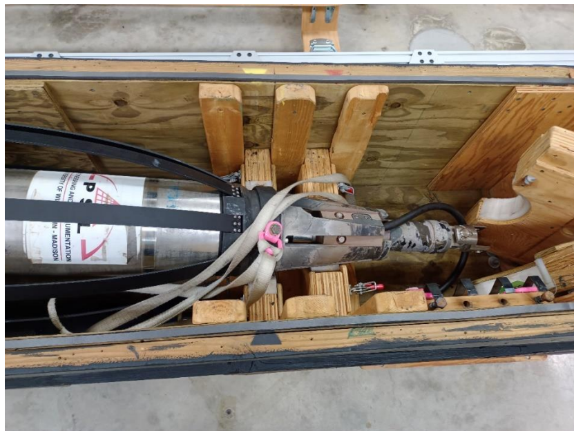
รูปที่ 24 เครื่องมือเจาะน้ำแข็งที่ขั้วโลกใต้ (driller)
