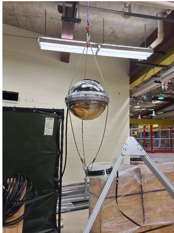
รูปที่ 24 ดอม (DOMs: Digital Optical Modules)
