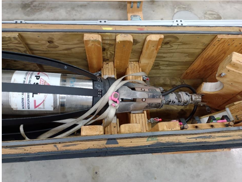
รูปที่ 23 เครื่องมือเจาะน้ำแข็งที่ขั้วโลกใต้ (driller)
